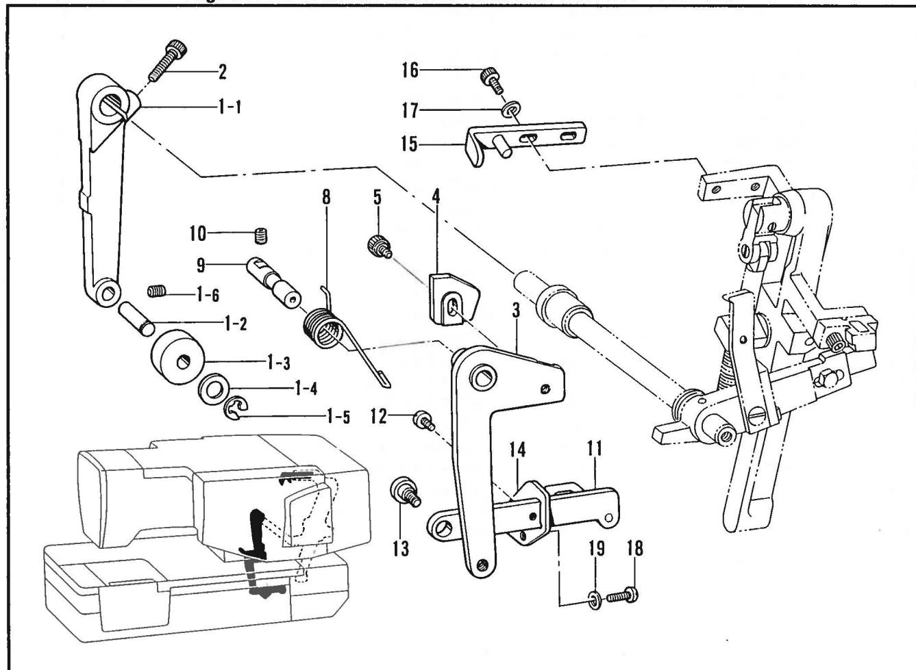
F. 減速関係 / Power transmitter mechanism / Kraftübertragungsvorrichtung /
