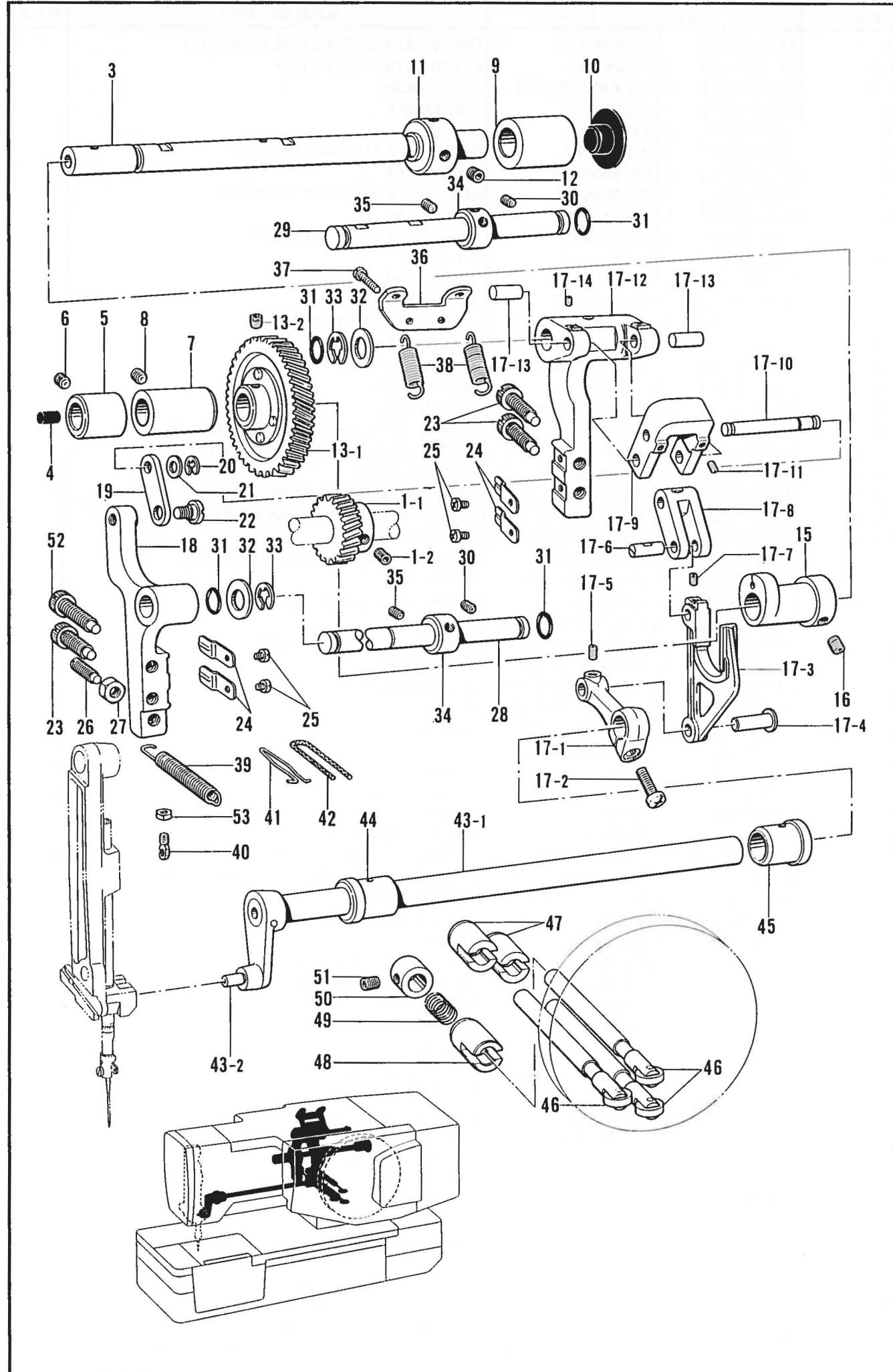
D. 針振関係 / Zigzag mechanism / Zickzackvorrichtung /
