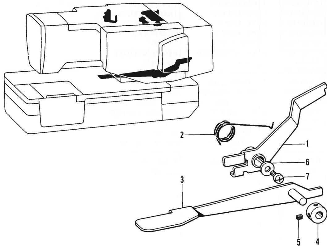
J. テンションブーリ関係 / Tension pulley mechanism / Spannrolle /
