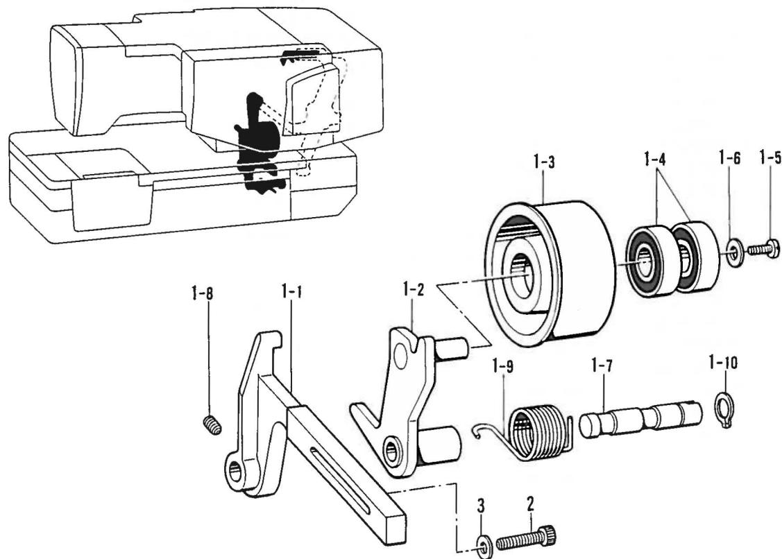
**H. 非常停止関係 / Emergency stop mechanism / Abschaltvorrichtung /
