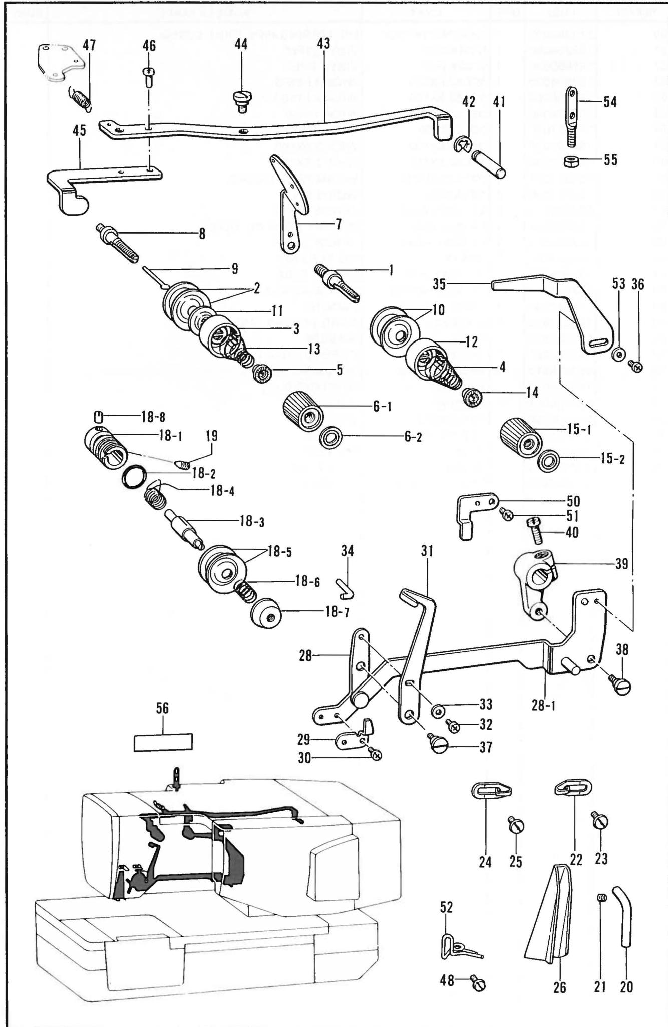
T. 糸通シ関係 / Threading mechanism / Fadenführungs vorrichtung /
