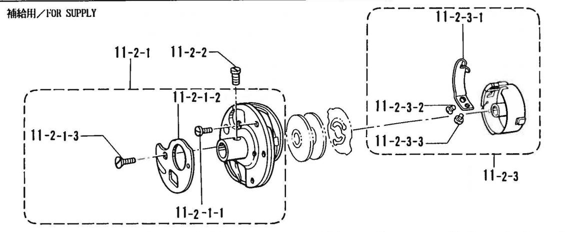
R. カマ関係 / Rotary hook mechanism / Greifervorrichtung /
