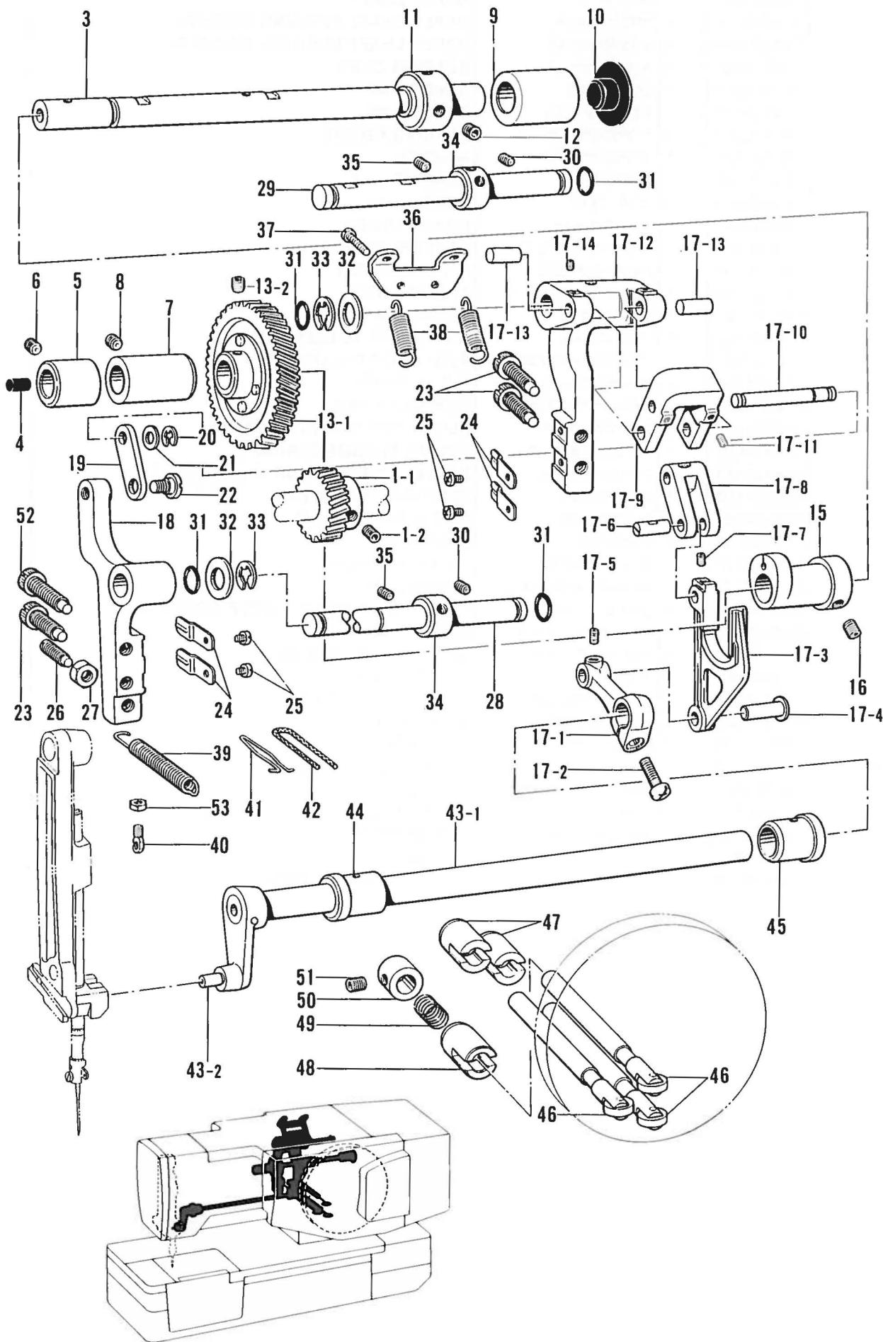
D. 針振関係 / Zigzag mechanism / Zickzackvorrichtung /
