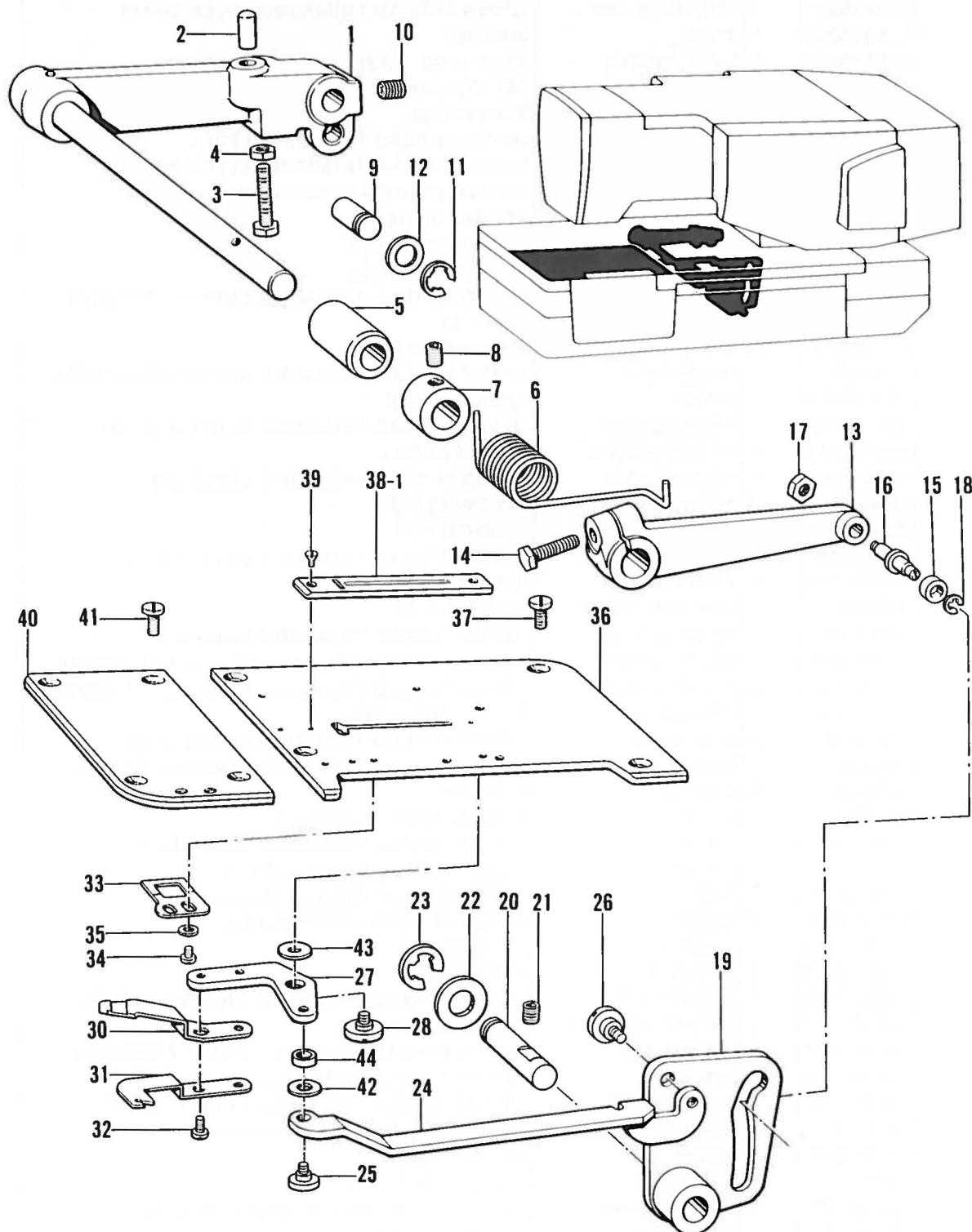
**W. 下糸切り関係 / Lower thread trimmer mechanism / Unterer Fadenabschneider /
