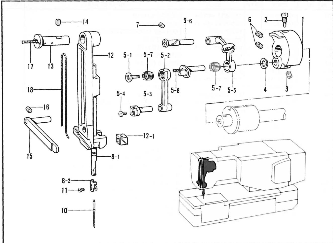
B. 針棒関係 / Needle bar mechanism / Nadelstangenvorrichtung /
