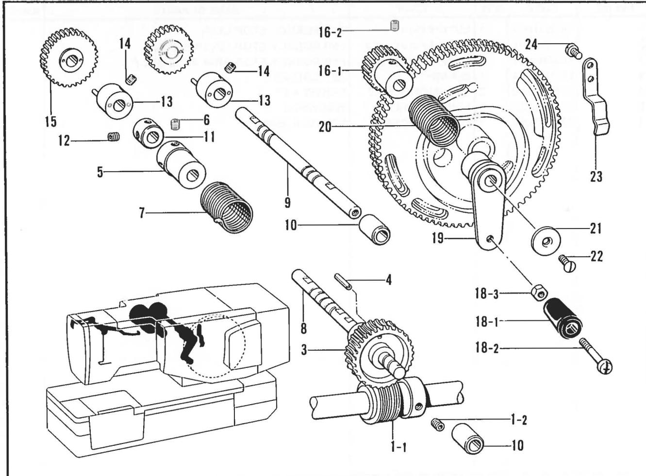
K. カム伝導関係 / Feed cam mechanism / Transporteurkurve /
