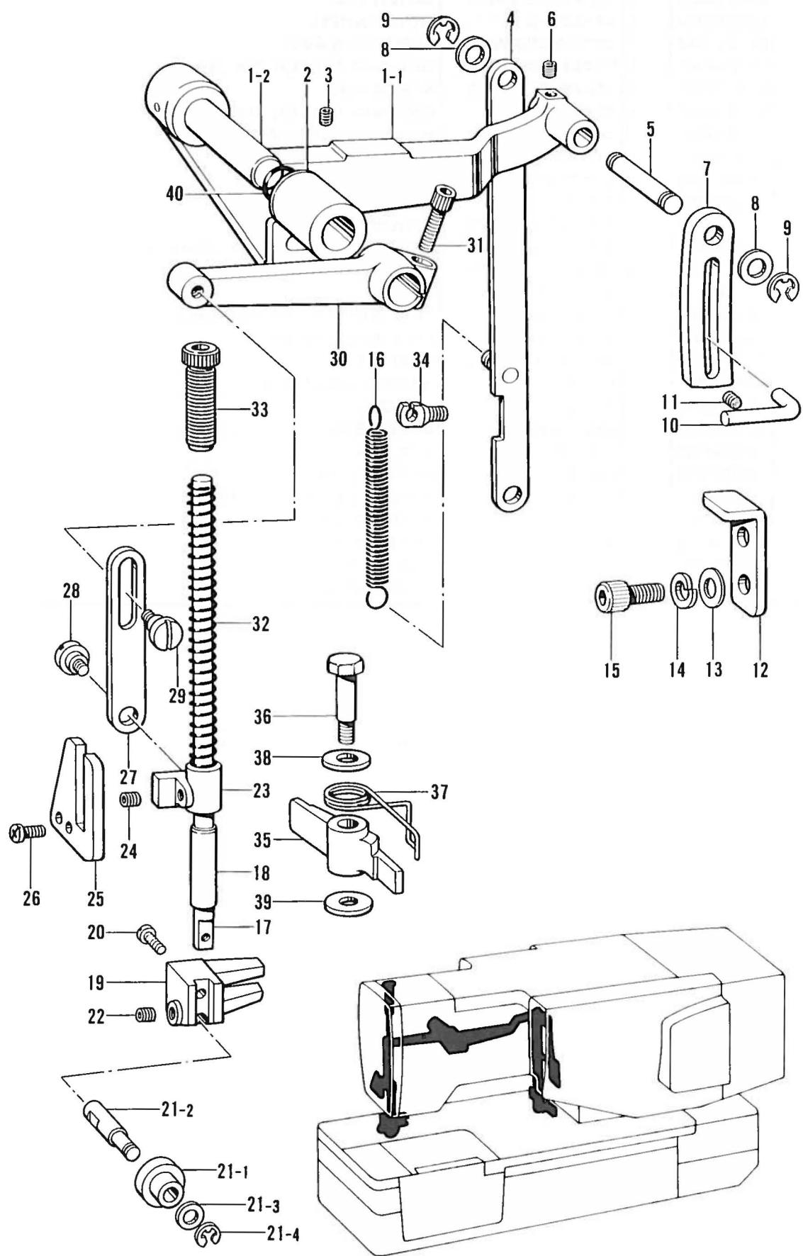
L. 押工関係 / Presser foot mechanism / Stoffdrückerfuß /
